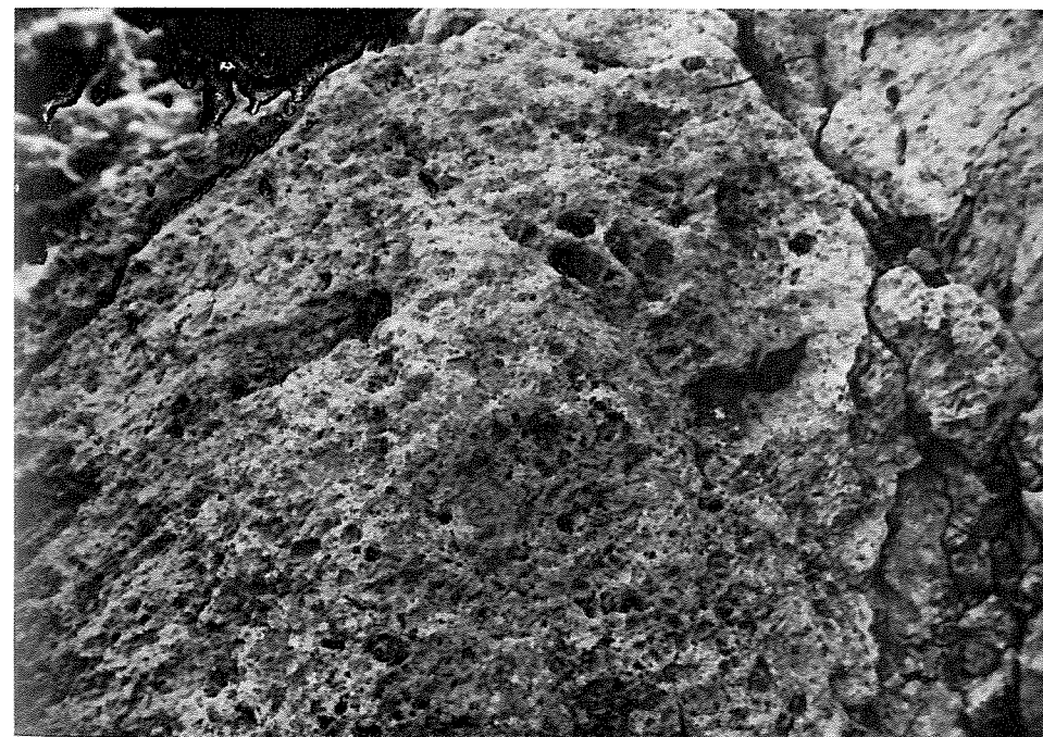
Fig. 4 - Alterazione più avanzata nel calcare cui le nicchie di erosione danno aspetto spugnoso.
