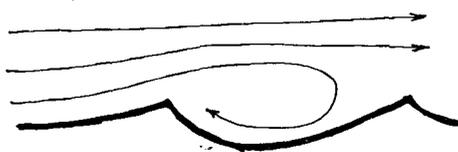
**Fig. 10 - Comportamento delle linee di flusso di una corrente fluida contro uno spigolo in una parete - formazione ed autosostentamento degli scallops.**
